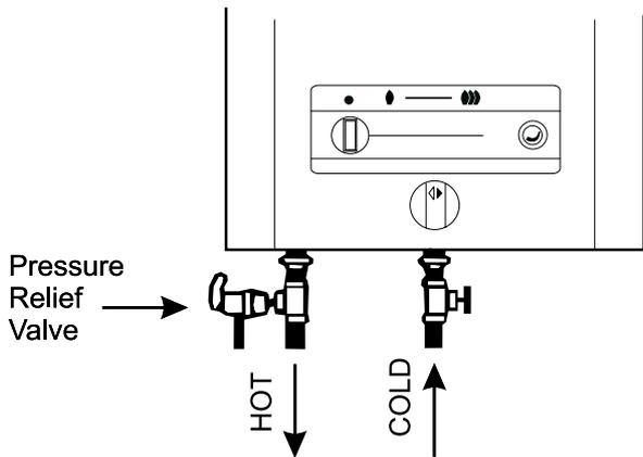
Fig. 4 - Pressure Relief Valve
